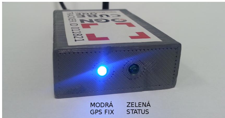
Modrá (levá) dioda značí stav GPS příjmu a po připojení k napájení bliká v 1s intervalu, dokud GPS nemá fix. Poté LED zhasne.
